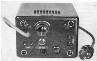
Bild 16. Rohrsummer der Stationen ab Nr. 15.
