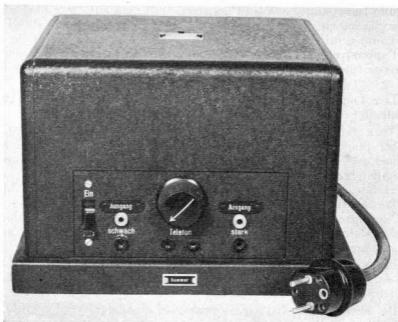
Bild 15. Rohrsummer der Stationen Nr. 1—6.
